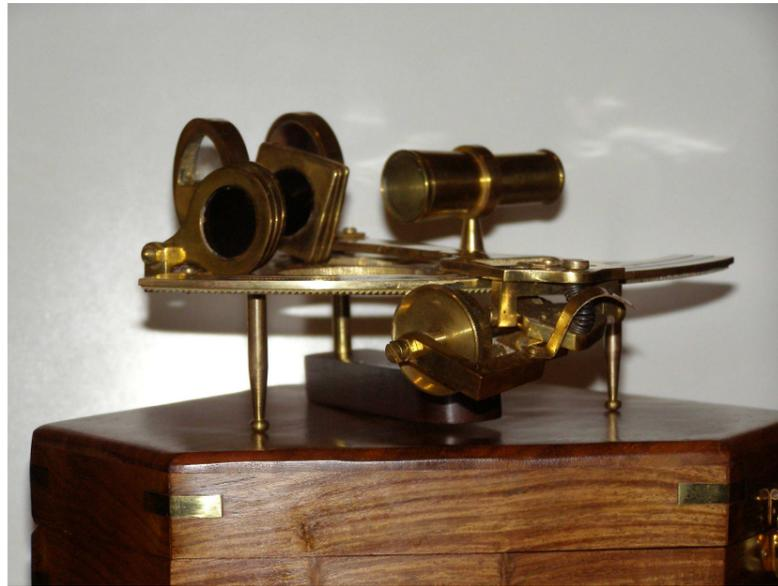
Un sestante, strumento per la misurazione dell'elevazione di un astro sull'orizzonte, sopra la sua custodia in legno
