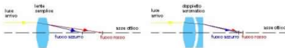
Fig. 1.3 - Come possiamo notare l'effetto dell'aberrazione cromatica tenderebbe a portare a fuoco due raggi, di diversa lunghezza d'onda, in due punti diversi dell'asse ottico (immagine a sinistra). Con l'introduzione di un altro elemento ottico si è però riusciti ad attenuare molto questo difetto (immagine a destra).
