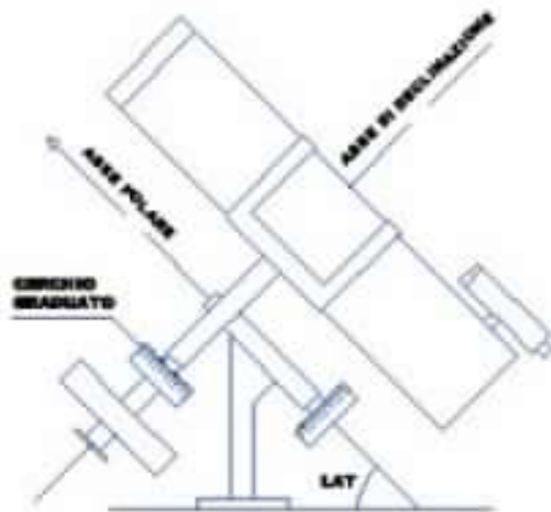
Fig. 4.1 - Nell'effettuare la messa in stazione di un telescopio equatoriale, per prima cosa dovremo impostare l'inclinazione dell'asse polare con un angolo pari alla latitudine del luogo, dopodiché si cercherà di puntarlo sulla Polare.
